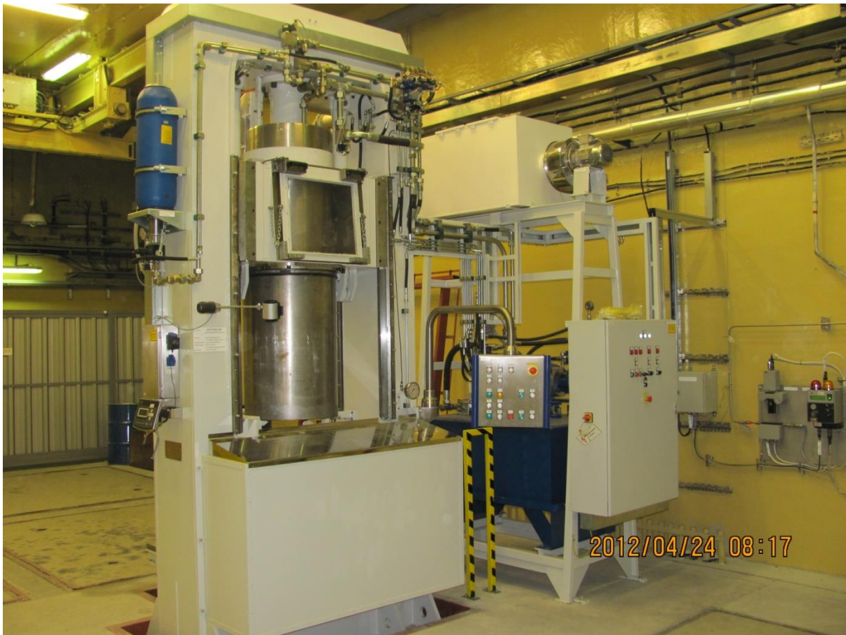
D.2.4 – 2. ábra Hulladéktömörítő prés
