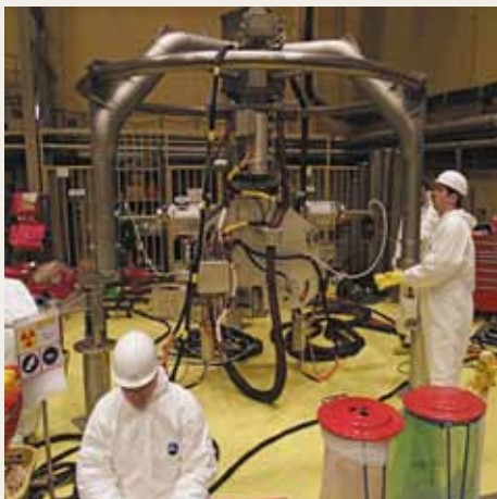
A reaktortartály roncsolásmentes anyagvizsgálatához szükséges manipulátor előkészítése
